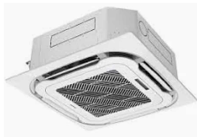
FANCOILS EXPANSIÓ DIRECTA, MODEL LG UT30F.NB0, DE 7,50 Kw O LGCT.18F NQ0 DE 5Kw, COL.LOCAT EN CEL RAS REGISTRABLE, I CONNECTAT A DESGUÀS
